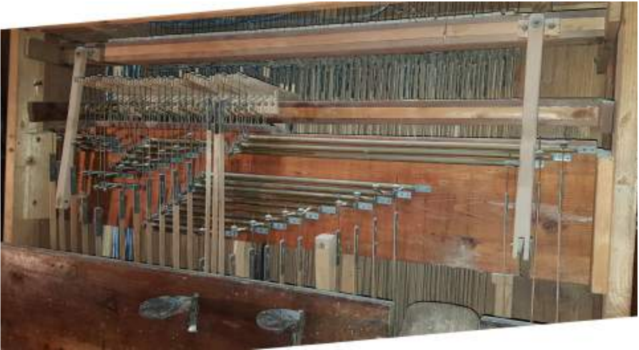
Le meccaniche contenute all'interno della consolle nella parte anteriore. In primo piano c'è la tavola di riduzione coi tiranti provenienti dalla pedaliera, che conduce ai soprastanti levismi mobili dell'unione col primo manuale.
