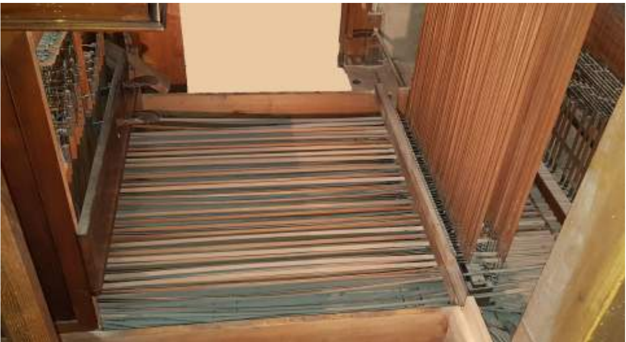
Il secondo e terzo tratto delle trasmissioni, quello orizzontale sotto la pedana della consolle in cui esistono tre livelli di tiranti per le due tastiere e la pedaliera (oltre ovviamente al fascio di tubetti di piombo nella parte bassa dell'immagine) e quello verticale in risalita verso le riduzioni sotto i somieri (le due serie ben visibili per le tastiere e il terzo per la pedaliera sullo sfondo a destra).
