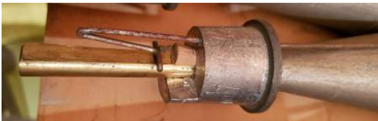
Dettaglio di una canna del Clarino: si notano la noce di piombo a sezione circolare su cui è saldata la tuba, il canaletto e la lingua in ottone fermati con un cuneo di legno, la gruccia di accordatura ferrosa con pattino forgiato direttamente sul filo.
