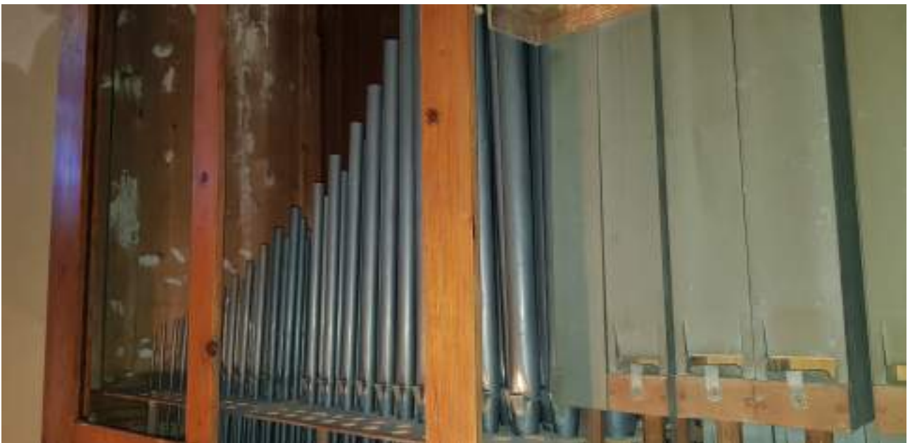
Vista delle canne del Principale, sulla destra quelle di legno coi grossolani freni armonici a lamina incidente.
