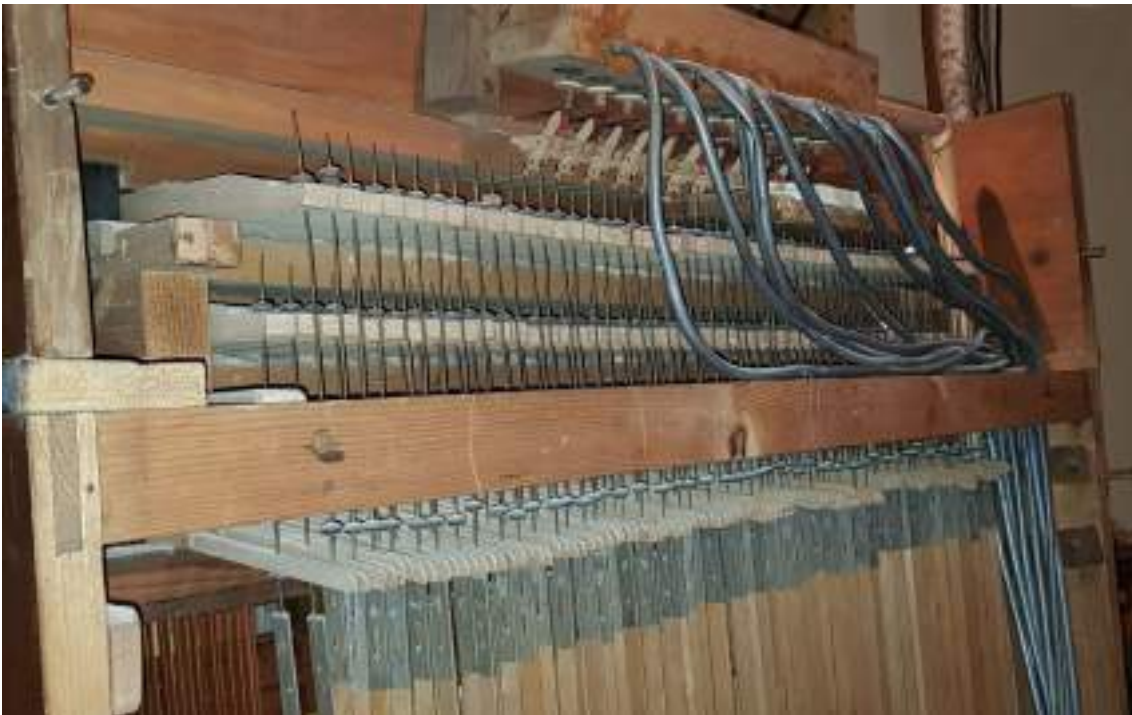
Altra vista delle trasmissioni, in cui si notano i levismi di azionamento delle valvoline sotto la scatola pneumatica dei registri, la discesa a pavimento dei tubi di piombo sulla destra e, più in basso, la serie di forcelle di legno funzionanti per l'unione delle tastiere.
