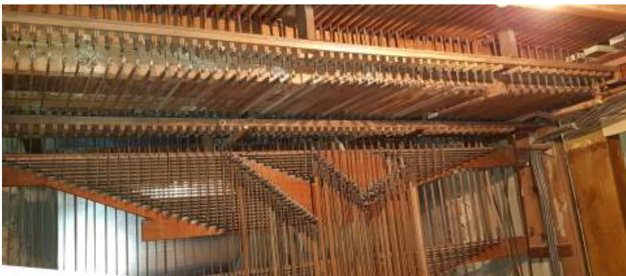
Vista della parte superiore dell'immagine precedente con primo piano della riduzione alla prima e successivo quarto tratto delle meccaniche, ossia quello in orizzontale sotto il piano dei somieri per l'azionamento delle barre per l'apertura delle valvoline coniche.
