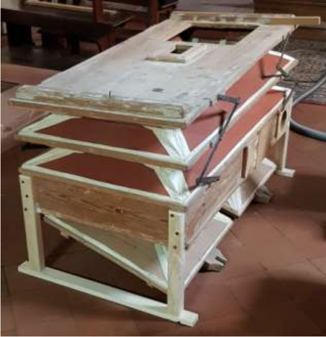
Il mantice aperto durante la manutenzione.
